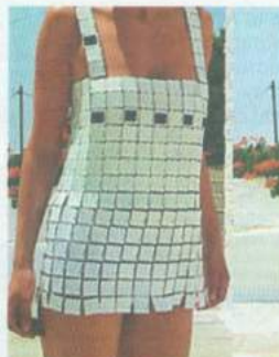
Εξυπνο ρούχο με ενσωματωμένες ζελατίνες φωτοβολταϊκών.
